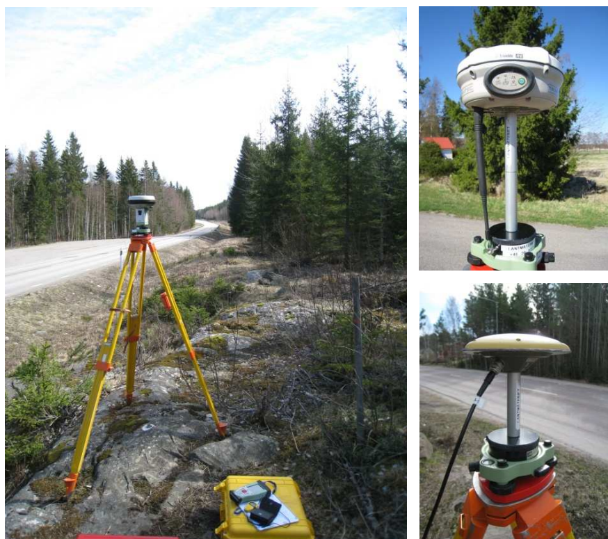
Figur 3: En typisk uppställning till vänster, här med Leica-mottagaren. Överst till höger syns Trimble-mottagaren och nederst till höger visas antennen från Topcon.
