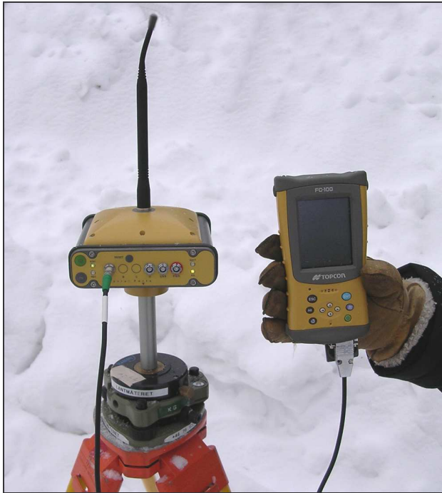
Figur 4.9: Topcon HiPer+ som användes för testmätningarna.
