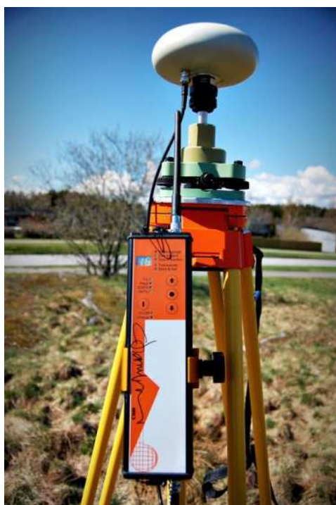
Figur 31: Antenn och mottagare monterade på stativ.
