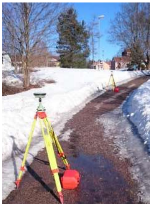
Figur 2: Inmätning av etablerings- (hitre) och detaljpunkt (bortre) med statisk GNSS-mätning.
