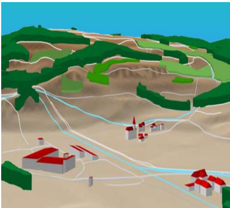
Förenklad bild av en topografisk landskapsmodell i 3D. På markmodellen visas vegetation och byggnader med höjd/volym hämtad ur en fotogrammetrisk ytmodell. Kartografiska teman i vektorformat höjdsätts med hjälp av markmodellen för att visas som liggande på markytan. (Bild: Swisstopo)
