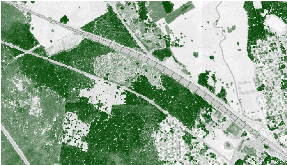
Figur 21 Textur och intensitet. Ledningsbryggor över en bangård med flera järnvägsspår framträder tydligt, liksom hjälpkraft- och återledningar där de förekommer.
