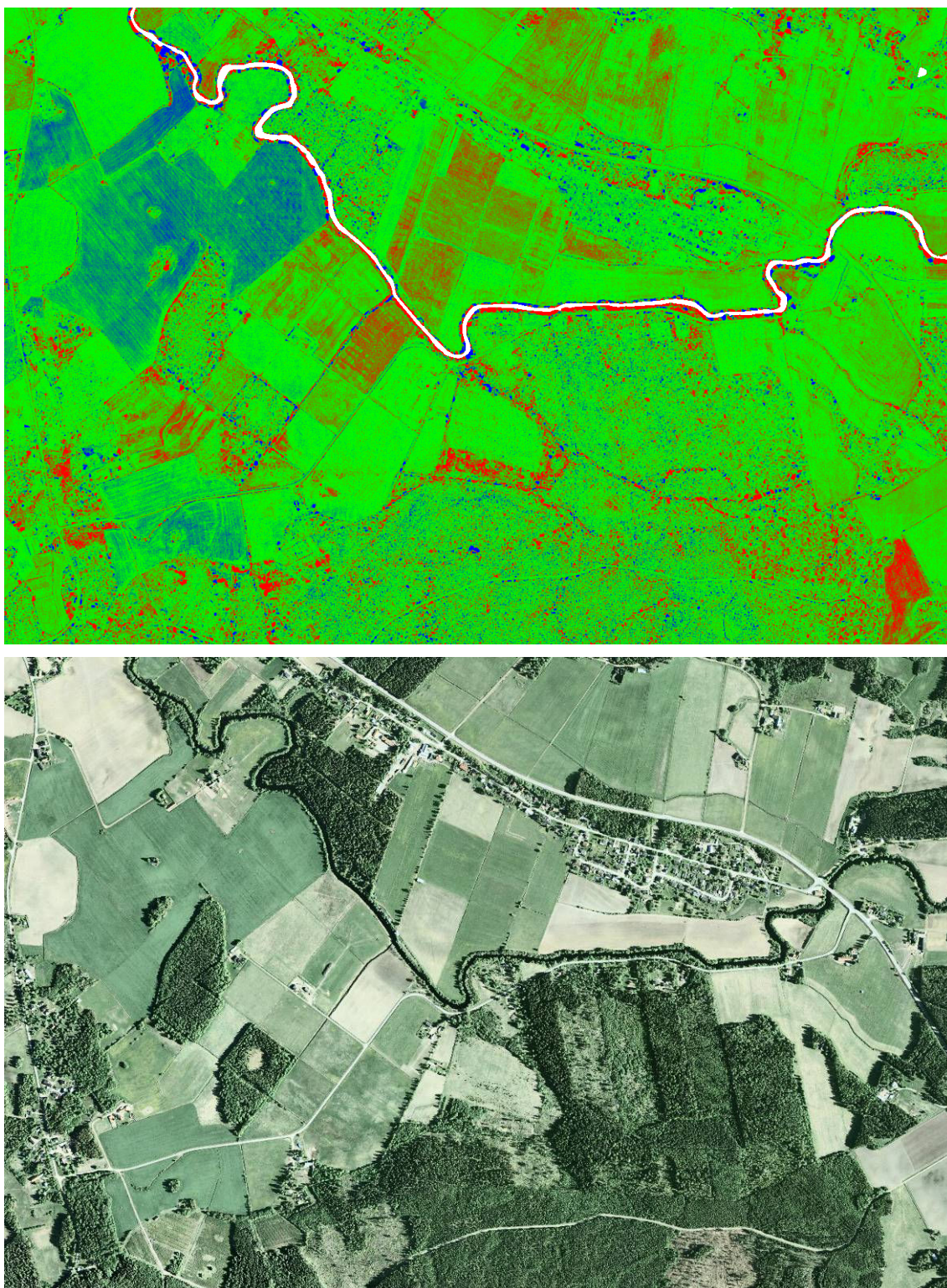
Figur 1 Den övre bilden visar differensen mellan två höjdmodeller skannade vid olika tidpunkter. Bilden är grön vid 0 och blir helt röd respektive blå vid \pm 0.4 meters avvikelse. Notera det allmänna bruset i skogsmark, samt hur odlad mark påverkas av gröda och årstid. Den nedre bilden är ett ortofoto med samma utsnitt.
