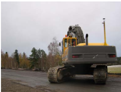
Figur 3: Maskinguidning med RTK är en tillämpning under snabb utveckling. Foto: Dan Norin.
