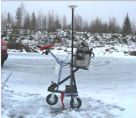
Figur 7: Med denna "RTK-kärra" inmättes 600-700 punkter/timme vid kartering av vägar m.m. i ett exploateringsområde i Borås. Foto: Jan-Olof Gustafsson, Borås stad.
