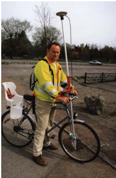
Figur 5: Cykelbaserad kartering av brunnar i Västerås med RTK-mätning. Foto: Jan Virking, Västerås stad.
