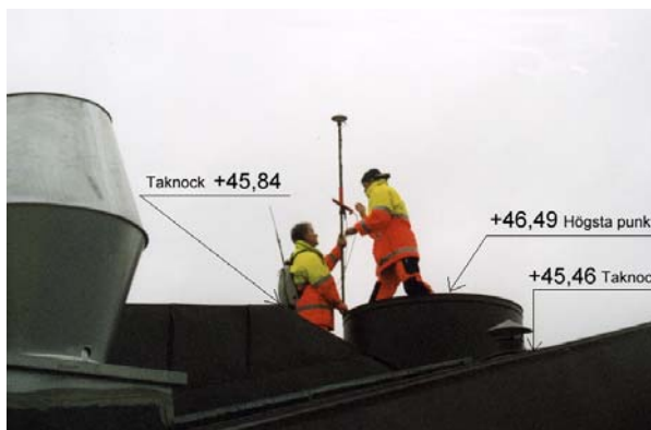
Figur 6: Användning av RTK-tekniken för att bestämma takhöjder i Stockholm. Foto: Peter Deagle, Stockholms stad.
