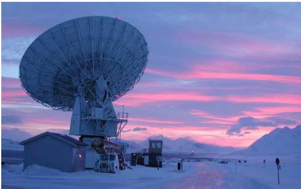
Figur 4: Statens Kartverks geodetiska observatorium i Ny-Ålesund på Svalbard med radioteleskopet för VLBI i förgrunden (foto: Statens Kartverk).
