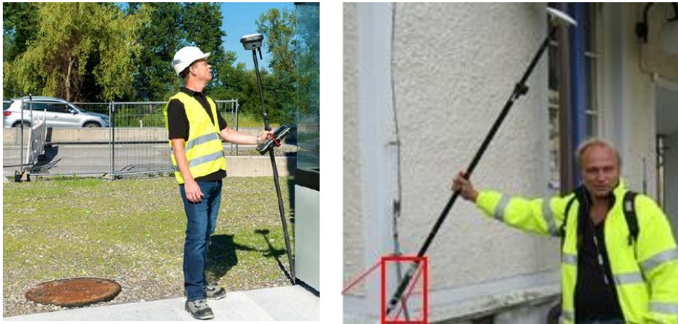
Figur 3.2: Hexagon visade den nya RTK-rovern Leica GS18 T, vilken har automatisk lutningskompensation av mätstången som bygger helt på tröghetsteknik (IMU). Redan 2004 visade det svenska GSE-projektet att detta var möjligt. Bilder: Leica Geosystems AG (vänster) och Borås stad (höger).
