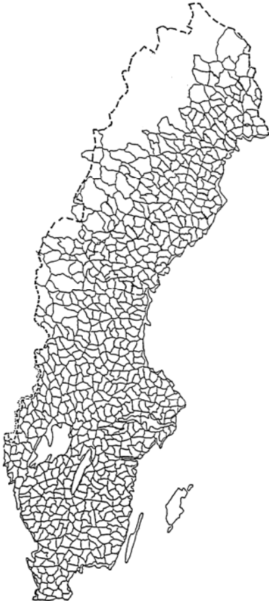
Figur 2: Nätkonfigurationen för tredje precisionsavvägningsnätet.
