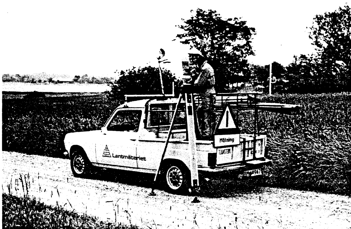
Instrumentbil - i samband med anslutningsmätningar till en fixpunkt
