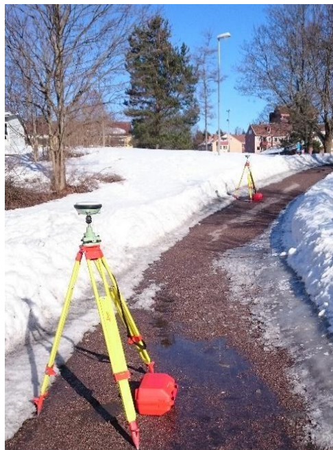
Figur 2: Inmätning av etablerings- (hitre) och detaljpunkt (bortre) med statistisk GNSS-mätning.
