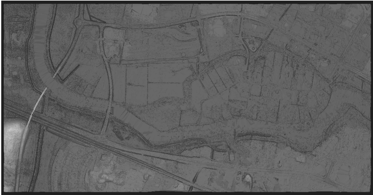
Figur 8: Höjdmodell framställd från laserdata. Modellen har samma utbredning som data från den höjdmodell som framställts med hjälp av flygbilder.
