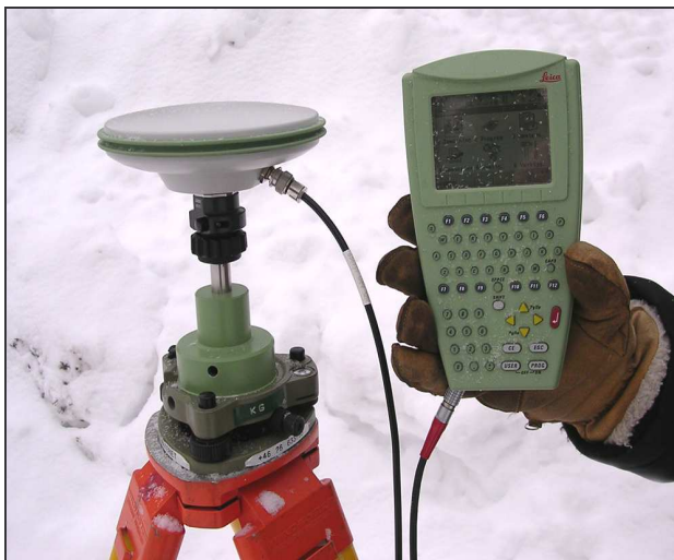
Figur 4.8: Leica GPS 1200 som användes för testmätningarna (på fotot saknas ryggsäcken med GNSS-mottagaren GX 1230 GG).
