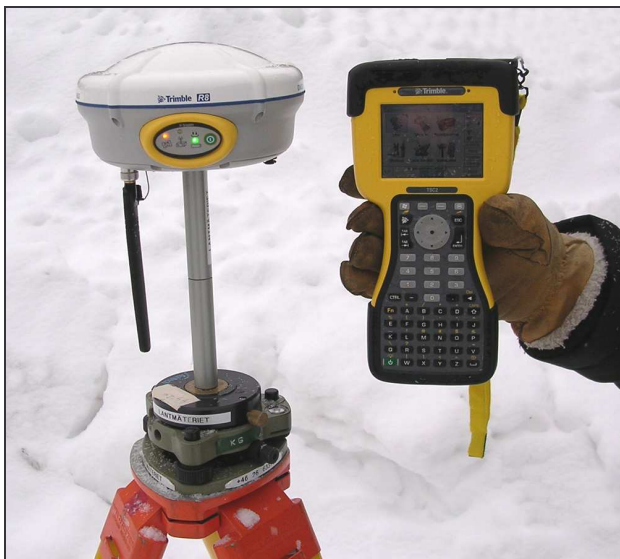
Figur 4.10: Trimble R8 som användes för testmätningarna.
