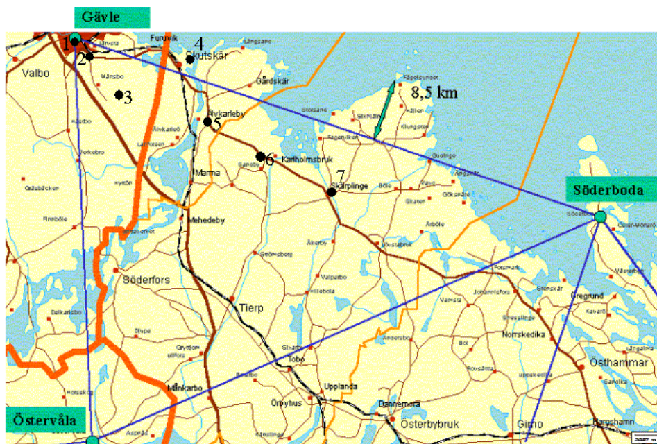
Figur 6.1: Testmätningarna har utförts vid sju olika punkter, belägna på olika avstånd från den fasta referensstationen i Gävle varifrån korrektionerna till enkelstationsmätningarna erhålls. Testområdet ligger inom nätverkstriangeln Gävle-Östervåla-Söderboda. Nätverkskorrektionerna beräknas m.h.a. interpolation från de sex närmaste referensstationerna (se figur 6.2).
