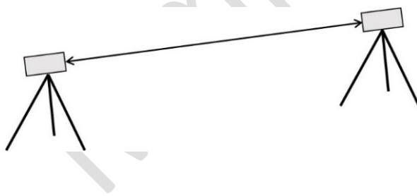
Figur 8. Principen vid korresponderande trigonometrisk höjdmätning (till vänster). Mätningen utförs samtidigt – kikare mot kikare eller mot en särskild måltavla placerad i förlängningen av totalstationens horisontalaxel (till höger).
