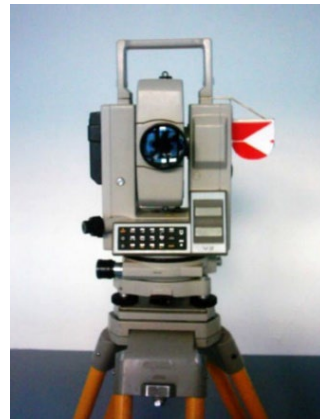
Figur 8. Principen vid korresponderande trigonometrisk höjdmätning (till vänster). Mätningen utförs samtidigt – kikare mot kikare eller mot en särskild måltavla placerad i förlängningen av totalstationens horisontalaxel (till höger).
