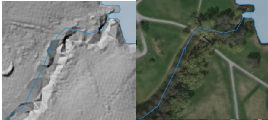
Figur 3.7.b. Exempel på dålig kombinerbarhet i plan mellan karterat vattendrag i 2D och terrängskuggad markmodell. Om höjdsättning av vattendraget görs med markmodellen så blir det fel i höjd eftersom vattendragets position ligger på land. För att uppnå kombinerbarhet måste vattendragets planläge först flyttas och sedan höjdsätts vattendraget i det nya korrekta planläget. Om vattendraget hade varit i 3D med korrekt höjdvärde så hade det hamnat under marken på grund av fel planläge. Den högra modellen visar att skymmande skog är anledningen till vattendraget karterats i felaktigt planläge. (Källa: Ramverk för Nationella geodata i 3D)
