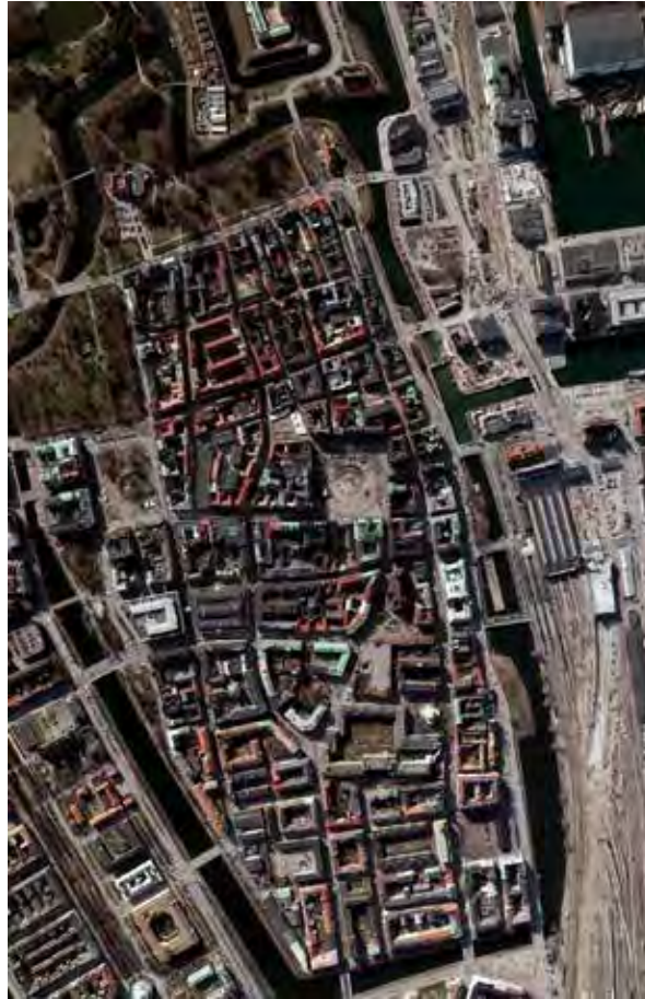
Figur 13.2. En flygbild över Malmö registrerad med digital flygmätkamera Vexcel Xp. Originalformat 104 x 69 mm. (Bild Blom Sweden AB. Godkänd för spridning)
