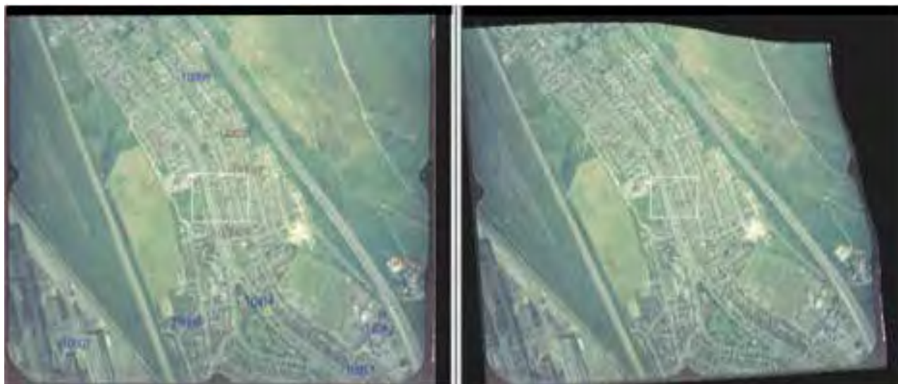
Figur 14.2. En flygbild (till vänster) och motsvarande ortofoto (till höger). Tydligt ligger en bergshöjd i bildens övre högra hörn. Bergshöjdens radiella deplacering i bilden har korrigerats i ortofotot.
