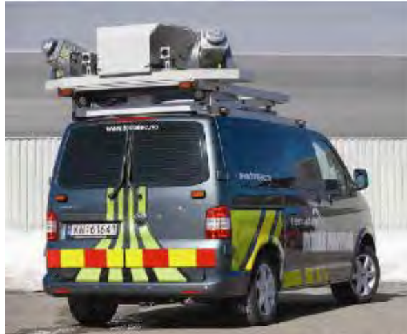
Figur 15.15. Fordonsburet integrerat sensorsystem (Lynx) med kameror, laserskannrar och ett integrerat navigationssystem (Terratec)
