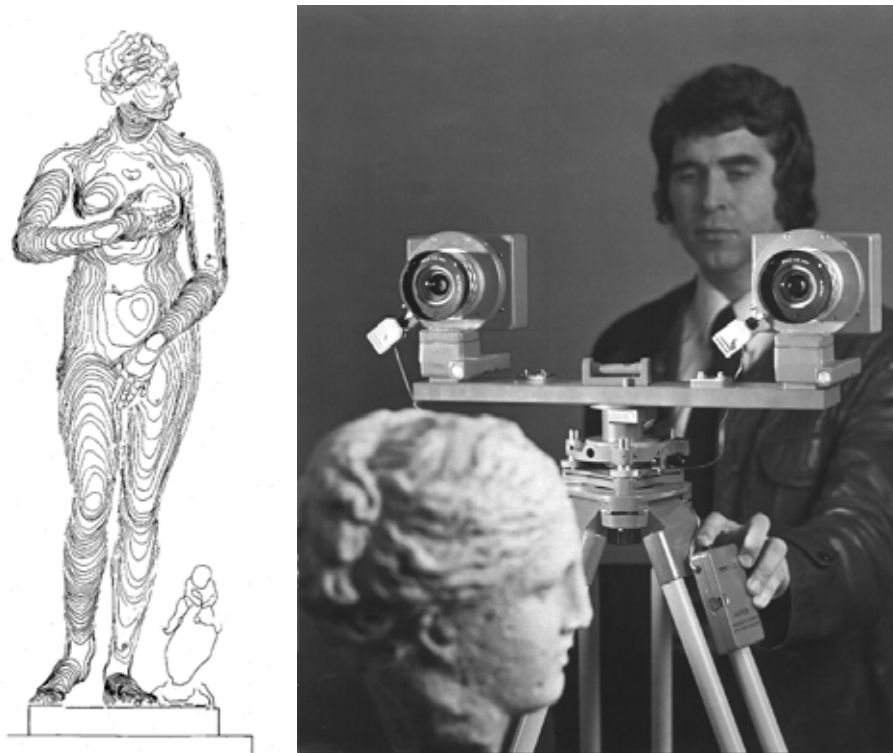
Figur 15.12. Stereokamera med fast bas (Leica/Wild P32), och exempel på uppmätt skulptur (KTH Fotogrammetri).
