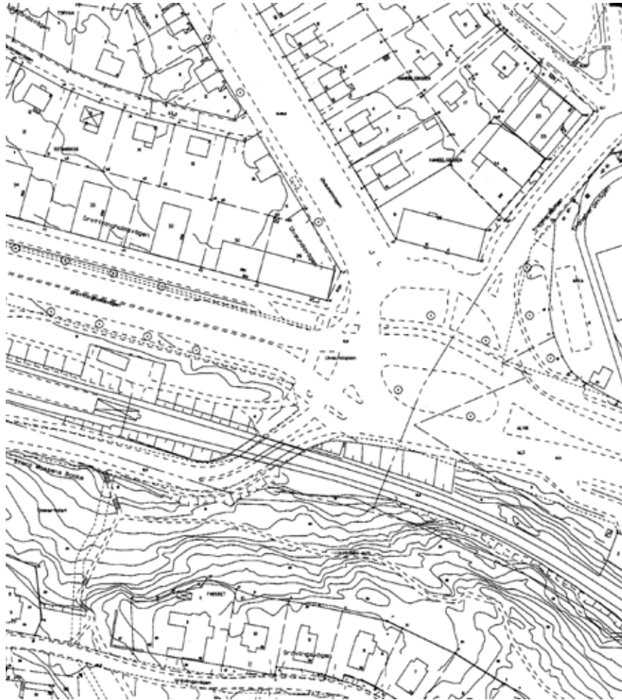
Figur 15.1. Exempel på kommunal primär- eller baskarta, här återgiven i skala ca 1:2000. (Stockholms stadsbyggnadskontor)
