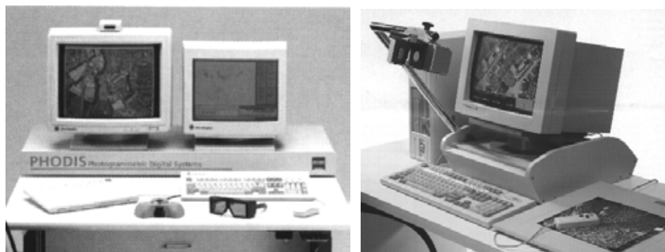
Figur 14.14. Fotogrammetriska arbetsstationer Zeiss Phodis ST resp. Leica DVP. Stereoseende åstadkoms här med "blinkmetoden" respektive med stereoskop och delad skärm.
