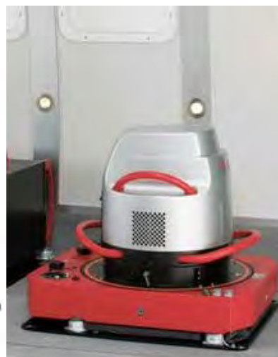
Figur 13.13. En trelinjeskanner (Leica Geosystems ADS 80) monterad i flygplanet, och dess marktäckning.
